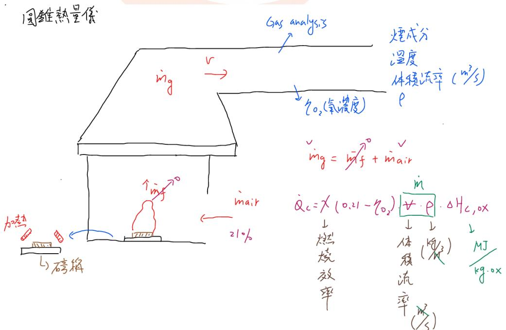
2. 圓錐熱量儀耗氧計算熱釋放率原理：
